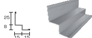
PROFILO a "Doppia L" 25X8X15x15 L=3050 mm
